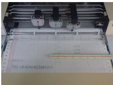
ファンクションジェネレータから0.3Hzを出力
