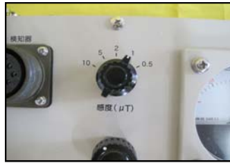
⑥「感度」切換器の感度を上げ指示計の振れを零に合わせ
