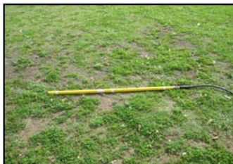
①検知器を磁気異常のない場所に置く
