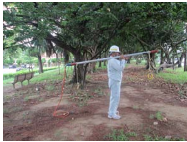
センサーを上下に30cm~50cm前後動かす
