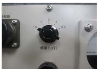
③「感度」切換器を「10」 \mu Tに設定
