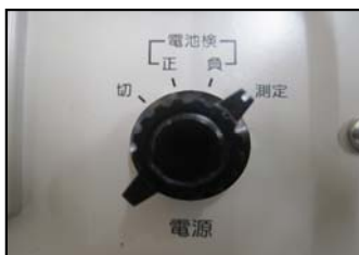
②管制器の「電源」スイッチを「測定」にする
