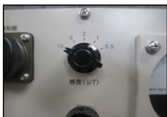
③「感度」切換器を「10」 \mu Tに設定
