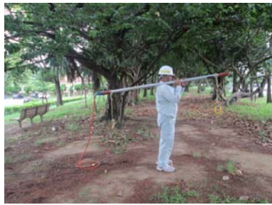
センサーを上下に30cm~50cm前後動かす
